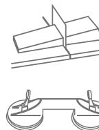
Se sugiere utilizar un sistema de nivelación para garantizar la planitud de la superficie y evitar desniveles y alturas irregulares entre piezas.
